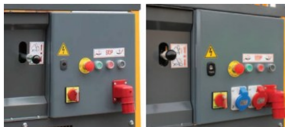
Bedieningspaneel: links elektrisch / rechts diesel met output van ingebouwd stroomaggregaat.
