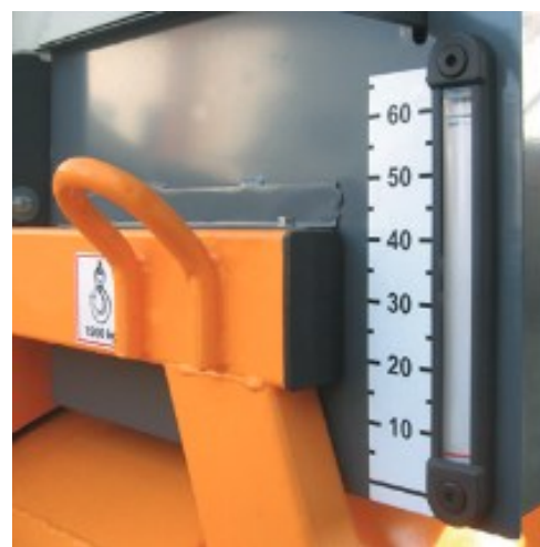
Waterniveau indicator en sterk hijsog.
